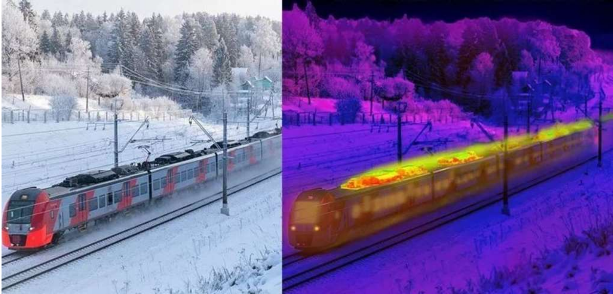
Тепловой след тормозящего электропоезда
